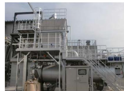
神戸工場では排水処理から出る余剰汚泥を乾燥させ、肥料としてリサイクルしています。
