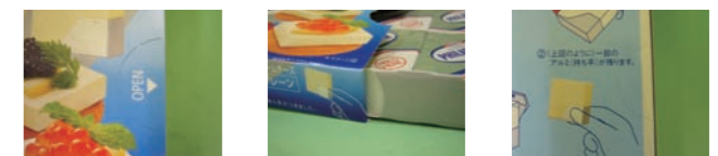
箱の開封場所に丸いミシン目(タンパープルーフ)を入れたことで、商品の開封が一目でわかるようになりました。 スライド式の箱に、抜け落ち防止のツメを設けました。 箱の底面にミシン目を入れ、廃棄時に箱を解体しやすくなりました。
