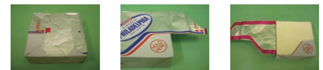
アルミ包装の改良: 赤いテアテープの形状を工夫して非対称にしたことで、アルミ包装を剥いたときに一部が残り、持ち手ができるようになりました。
